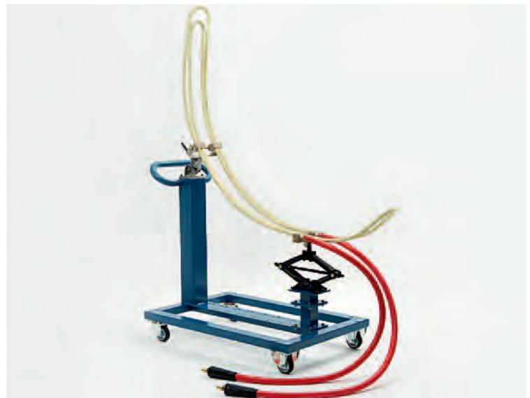
Positionierer mit starrem Forminduktor
